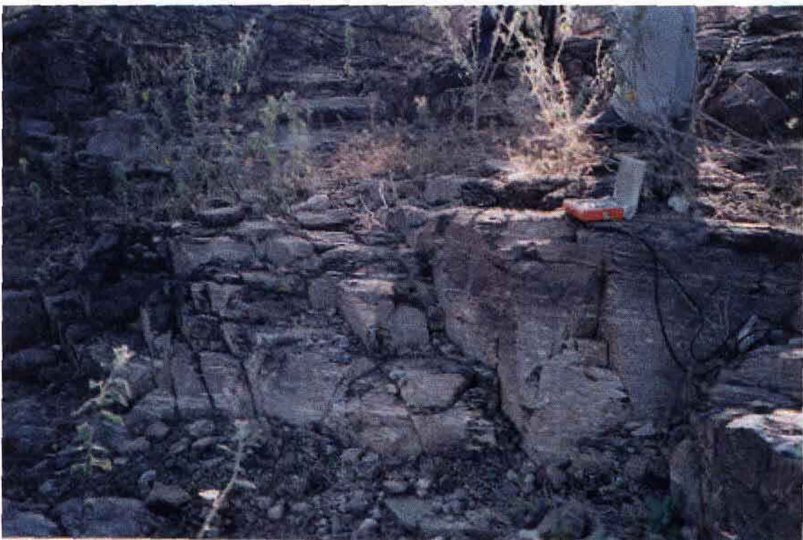
FOTO 5 – Visão geral das fraturas leste-oeste, com aberturas superficiais e preenchimento fino (foto com vista para sudeste).
